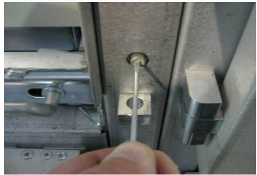
Рис. 2.23 Механизм деактивации блокировки (вид при открытой двери отсека)
