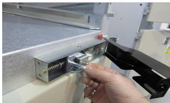
Рис. 2.29 Порядок деактивация блокировки (шаг 1)
