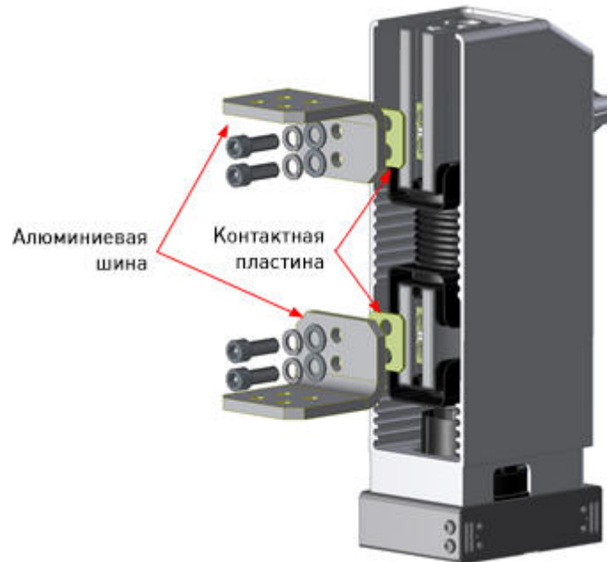
Рис.6.2. Монтаж контактных пластин
