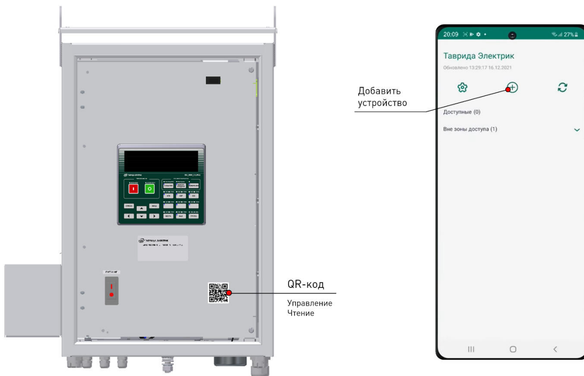
Рис.8.10. Подключение к реклоузеру с помощью приложения
