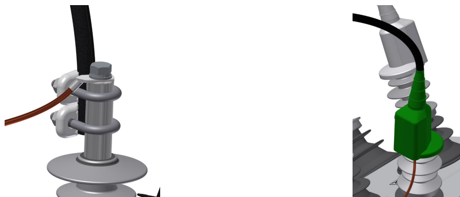
Рис.4.80. Подключение проводов к реклоузеру
