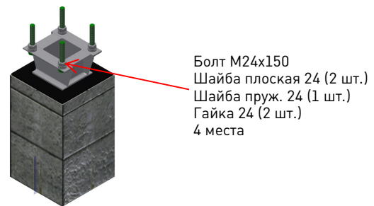
Рис.4.2. Установка регулировочных болтов
