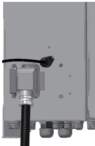
Рис. 4.8. Подключение кабеля оперативного питания к шкафу управления
