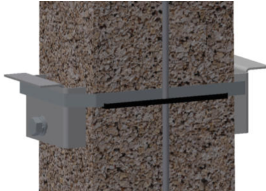
Рис. 4.46. Установка держателей для шкафа управления и шкафа учета
