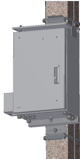
Рис. 4.28. Установка шкафа управления
