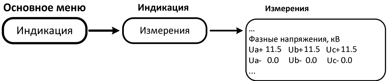
Рис. 5.5. Просмотр наличия напряжения с панели управления
