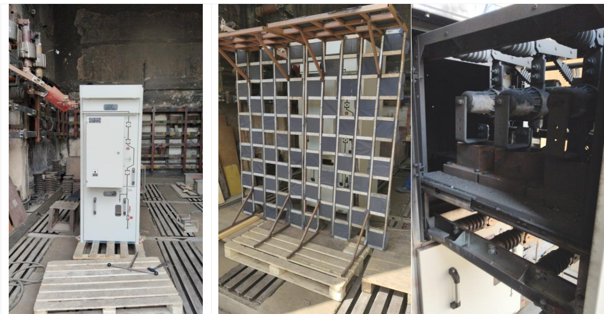
Рис. 12 Испытания камеры КСО на локализационную способность
